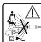
Vysokotlaké čističky mohou být při ne-správném používání nebezpečné. Jejich proud vody nesmí být namířený na osoby, zvířata, na aktivní elektrickou výstroj anebo na samotný tento nástroj.
