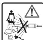
En cas d'utilisation non conforme, les nettoyeurs à haute pression peuvent être dangereux. Le jet ne doit pas être dirigé sur des personnes, des animaux, de l'équipement électrique en fonctionnement ou sur l'appareil lui-même.
