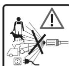
Przy nieprawidłowym użyciu myjki wysokociśnieniowe mogą być niebezpieczne. Strumienia nie wolno kierować na ludzi i zwierzęta, znajdujące się pod napięciem urządzenia elektrycznego czy na samo urządzenie.
