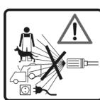
Przy nieprawidłowym użyciu myjki wysokociśnieniowe mogą być niebezpieczne. Strumienia nie wolno kierować na ludzi i zwierzęta, znajdujące się pod napięciem urządzenia elektrycznego czy na samo urządzenie.
