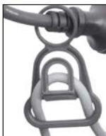
Formen Sie aus dem Ende des Verlängerungskabels eine Schlaufe und hängen Sie diese in die Zugentlastung (19) am Netzkabel (7) ein.
