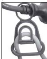
Ilginamojo kabelio gale padarykite kilpą ir įkabinkite ją į tinklo kabelio traukimo jėgos sumažinimo įtaisą (7)
