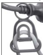
Forme un bucle con el extremo del cable de prolongación y cuélguelo en el sistema de descarga de tracción (19) del cable eléctrico (7).
